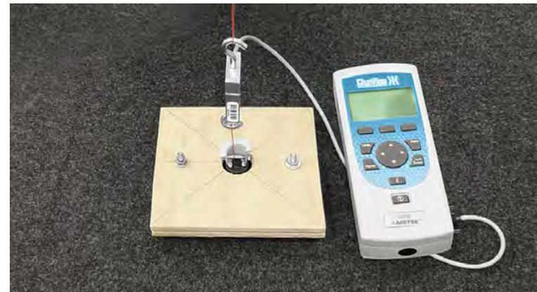
Pruebas de la resistencia del elemento de fijación
